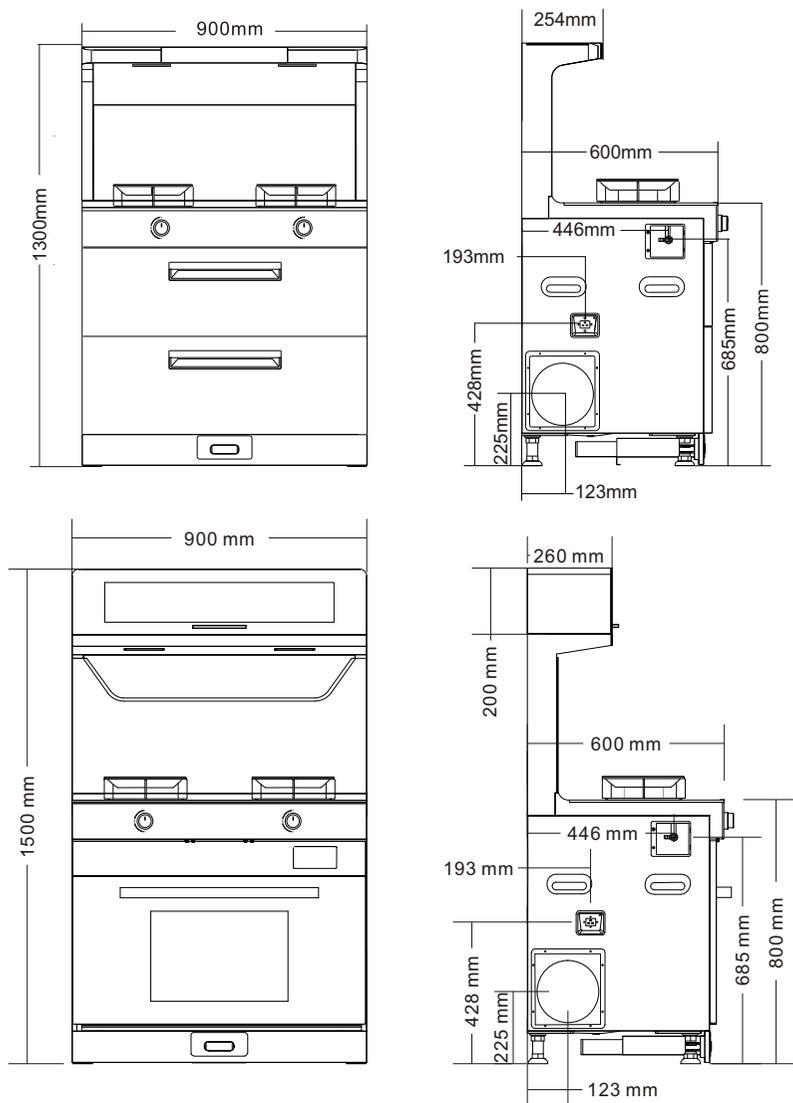
■ 右侧排烟安装尺寸图, 如左侧排烟需与下图相反方向(单位:mm)。
